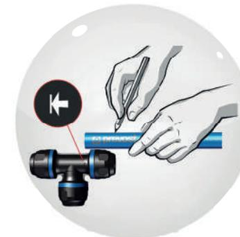
Tracciare un segno sul tubo per verificare la posizione del tubo nel raccordo prima del serraggio (utilizzare la tacca sul raccordo o sulla chiave di serraggio).
