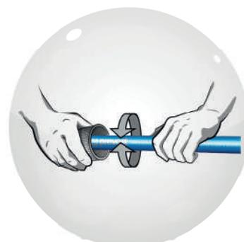
Smussare l'esterno del tubo per facilitare l'inserimento ed evitare di danneggiare la guarnizione. Un leggero smusso interno permette di eliminare gli eventuali residui di taglio. (cod. PPS CH).
